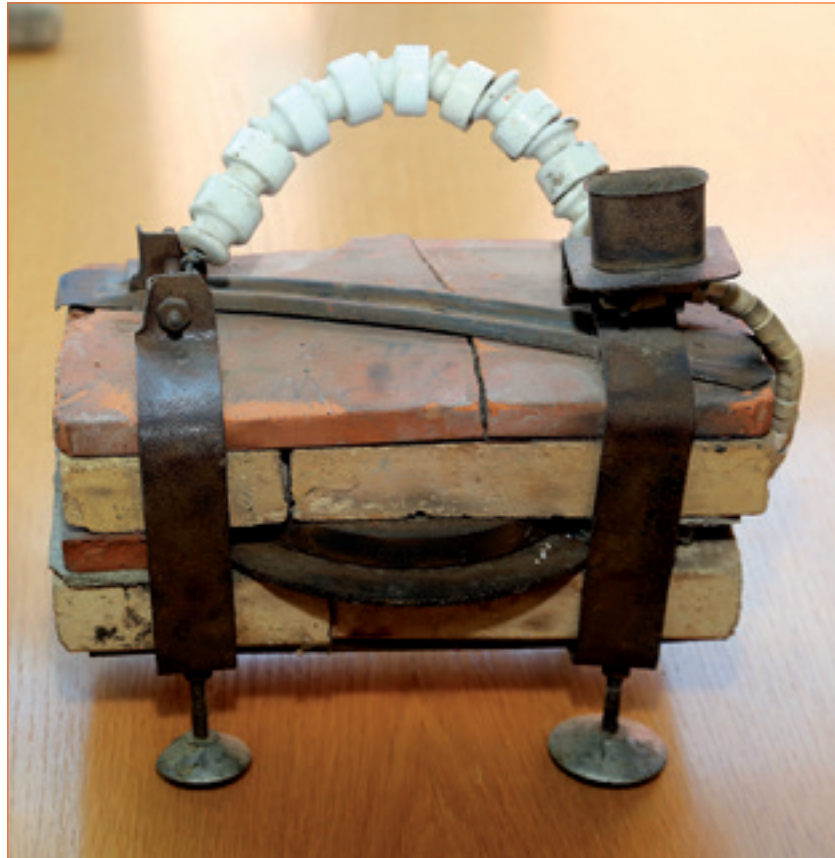
Selbstgebauter elektrischer Ofen aus Schamottesteinen und Dachziegeln Foto: Niels P. Jørgensen
